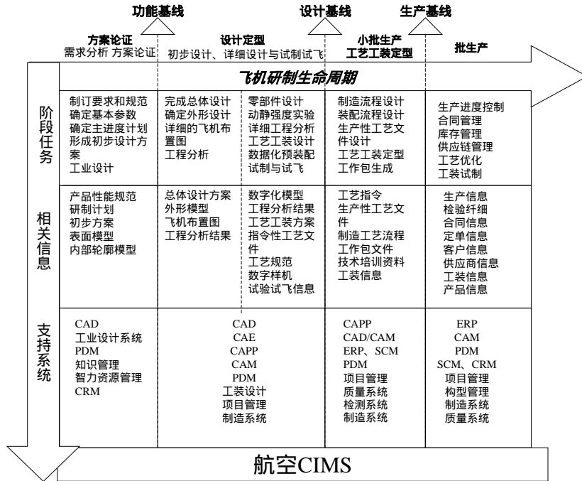
图 1 飞机研制过程不同阶段的工作内容、信息和支持系统关系图
